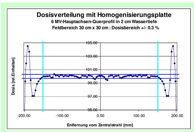
Bild 3 Querverteilung nach der Homogenisierung
